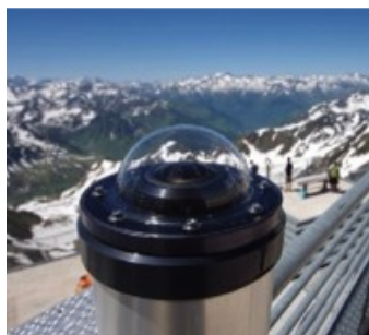
Figure 6.3.2.4 - Les caméras multiples Fisheye (vision grand angle hémisphérique) du réseau FRIPON permettent une couverture globale du territoire.
