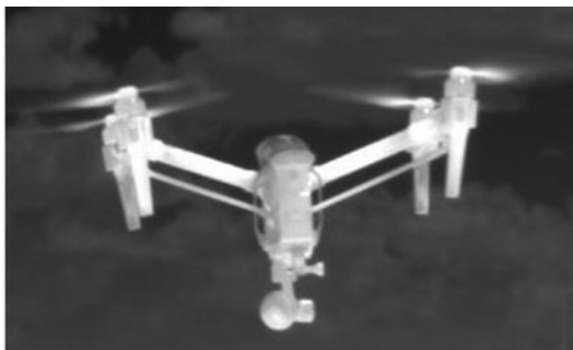
Figure 5.2.1.1 : image thermique de micro drone en bande 2 (émission type corps gris)
