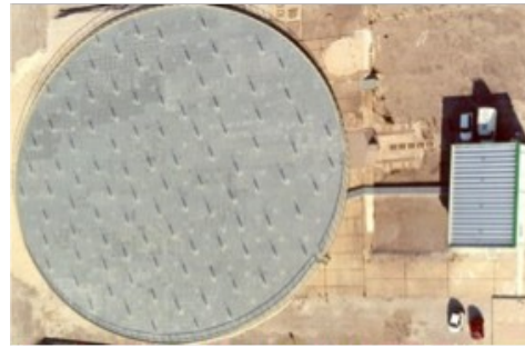
Figure 6.2.10 - Radar bistatique de surveillance de l'espace Graves - antenne de réception
