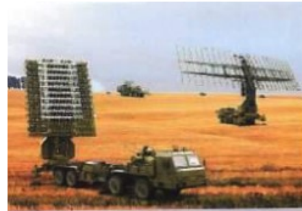
Figure 6.2.2 : exemple de radar multifréquence multifonction pour détecter, poursuivre et guider des cibles furtives traversant l'atmosphère (entre 100 km d'altitude et les couches plus denses en dessous de 10 km)
