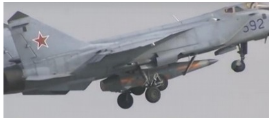
Figure 5.12.3.4.2.3 : Missile balistique manœuvrant Kinzhal tiré d'avion M10
