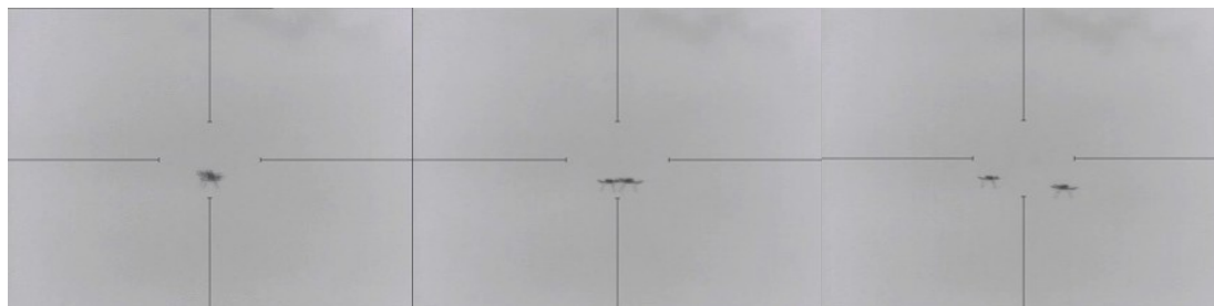
Figure 4.2.4.3.7 – observation de drones en formation serrée par une caméra visible (a) confondus - (b) début de séparation - (c) image résolue – deux drones
